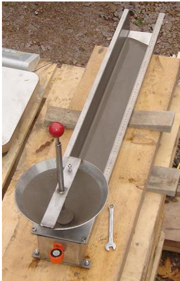
Abbildung 1: Fließrinne für die Konsistenzprüfung
