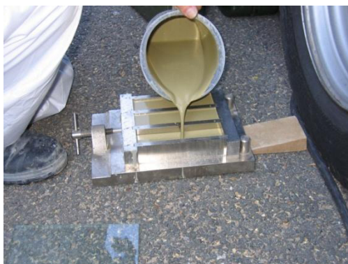
Abbildung 3: Herstellung von Probekörpern für die Festigkeitsprüfung auf der Baustelle
